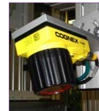
Kamerasystem zum Gegenlesen des direkt gelaserten Datamatrixcode
