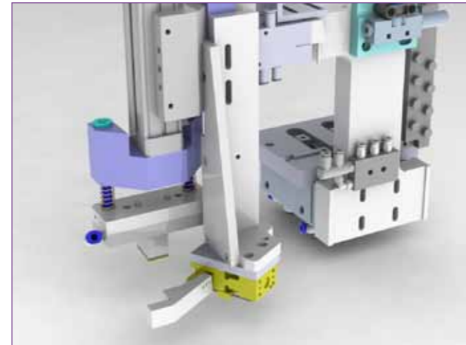
Etikettenzentrierung – Greifbacken geöffnet
