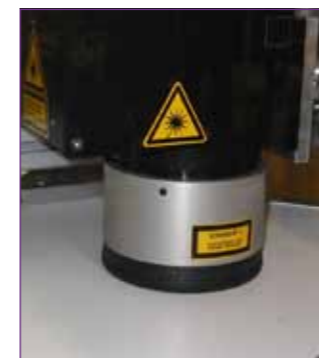
Laserschutzverkleidung gemäß Laserschutzklasse 1
