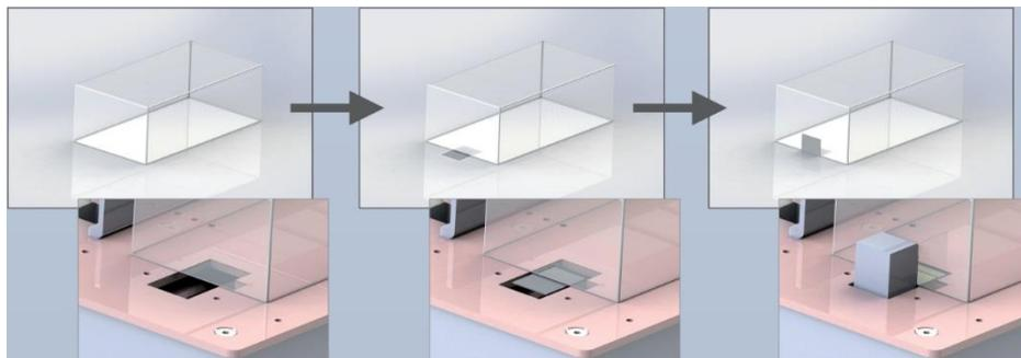
Bei der halbautomatischen Lösung legt der Bediener ein Produkt lagerichtig auf die Maschine und löst die Etikettenspendung aus. Im weiteren Verlauf wird das Etikett automatisch zur Hälfte am Boden, zur anderen Hälfte um die Einsteckklase seitlich auf die Faltschachtel angedrückt.
