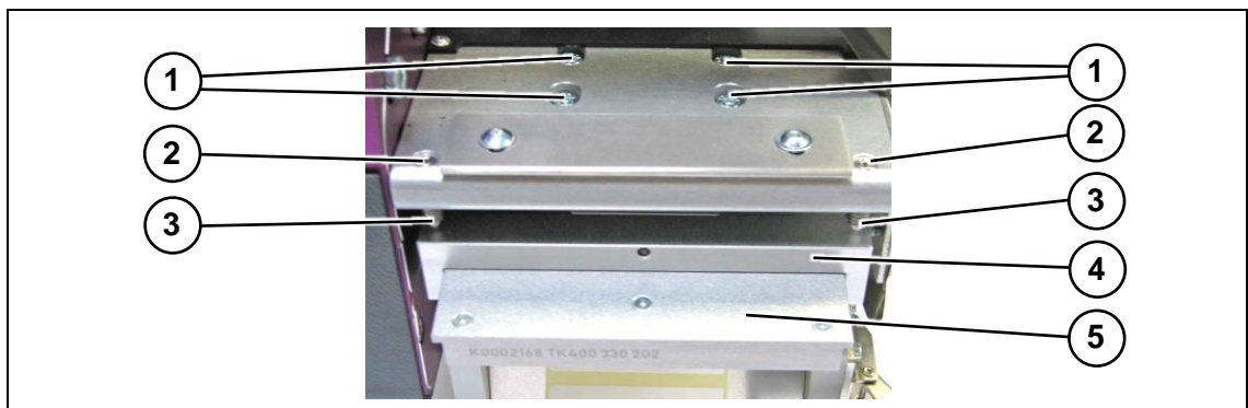
Abbildung 32 Druckkopf mit herausgezogener Thermoleiste – Blick von oben
