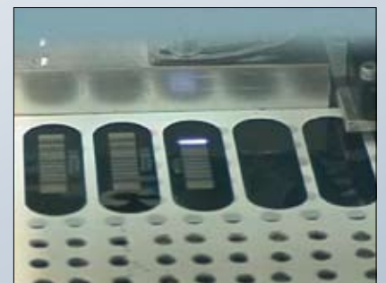
Beschriftung von vorgestanzten Laseretiketten
