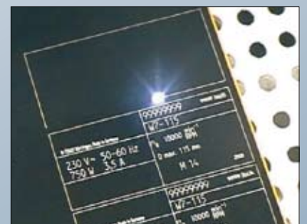
Beschriftung und Schneiden von Endlasermaterial
